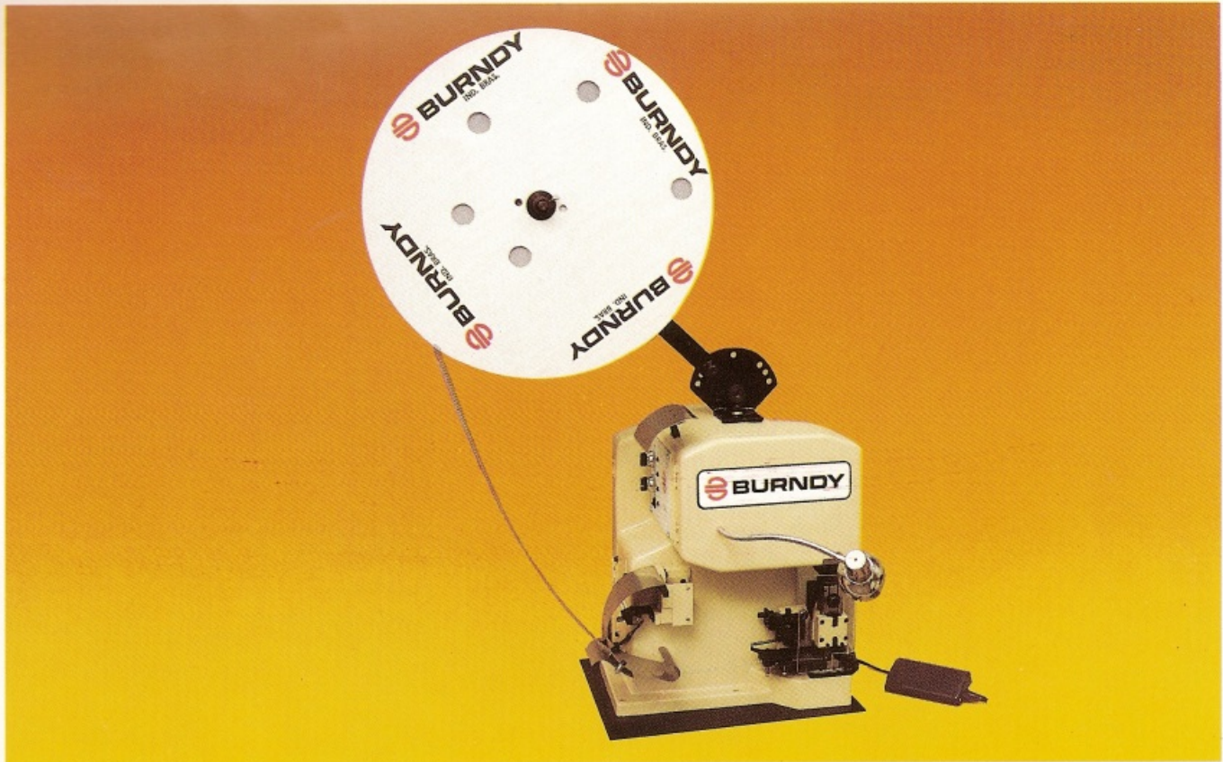
Prensa UTM , nova tecnologia Burndy , com ajuste rápido para a altura de crimpagem de diferentes bitolas.
